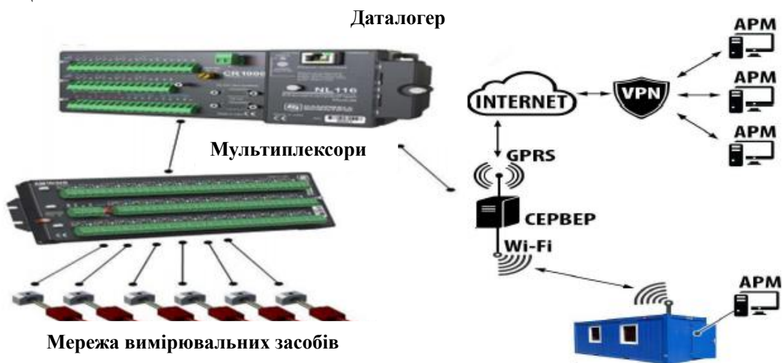
Рис. Принципова схема автоматичної системи моніторингу
