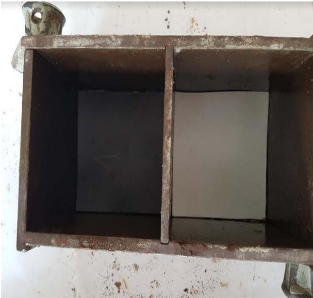
Рис. 5. Розміщення зразків Mare 1400 та ORCA 828 на дні форми
