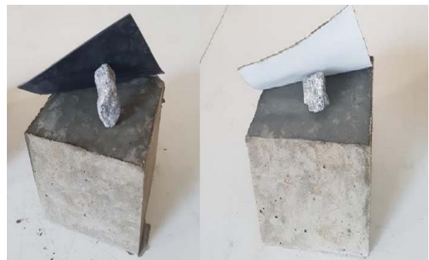
Рис. 8. Демонстрація відсутності адгезії між зразками та бетонною сумішшю
