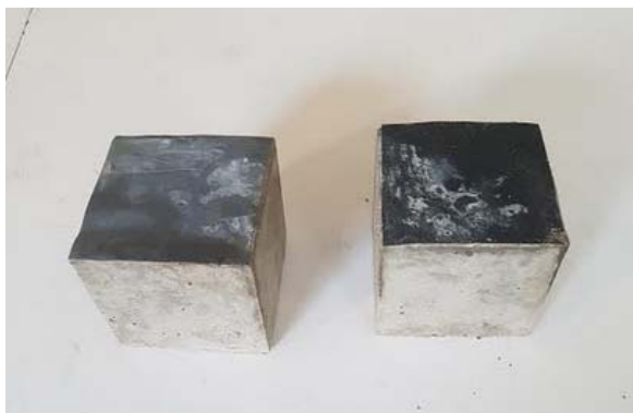
Рис. 7. Бетонні куби зі зразками матеріалів після випробування
