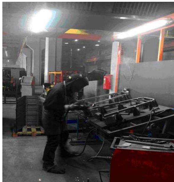
Рис. 3. Модернізований зварювальний стіл електрозварника
