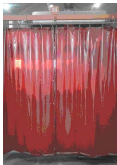
Рис. 4. Захисні екрани робочого місця електрозварника
