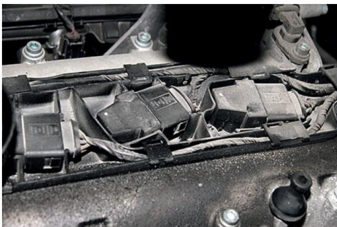
Рис. 2.1. Відмова індивідуальних котушок запалювання
