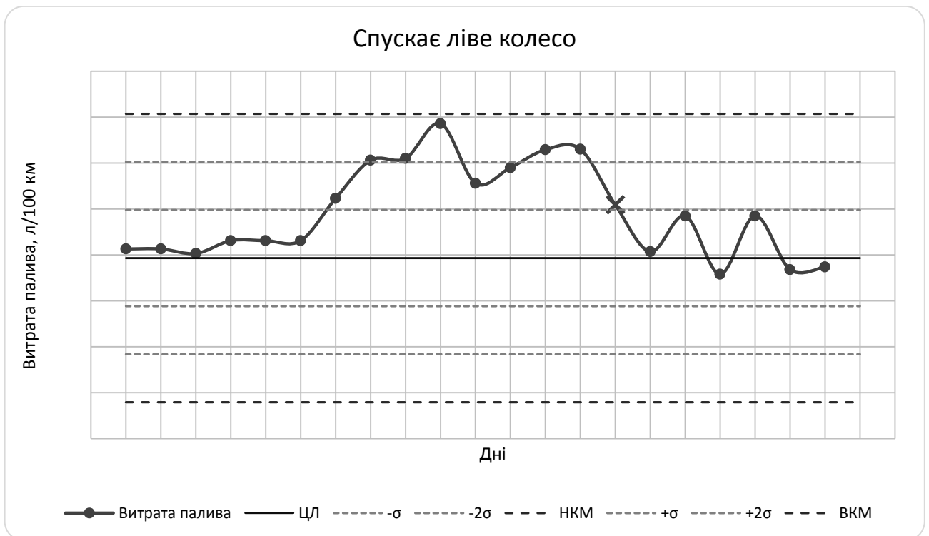
Рис. 3.3. Контрольна карта Шухарта витрати палива в л/100 км при спусканні лівого внутрішнього колеса
