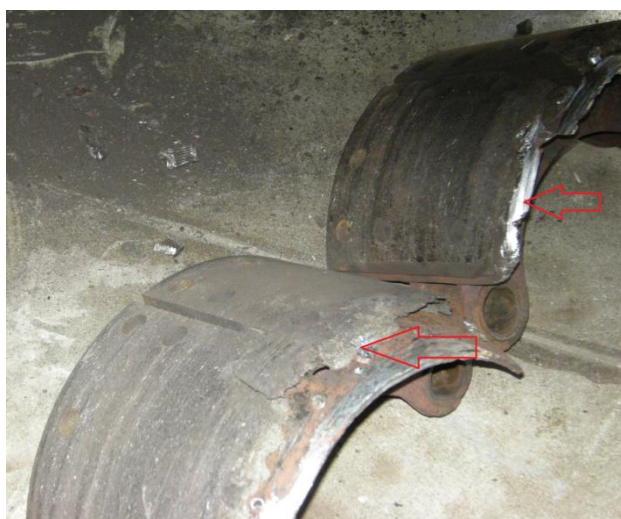
Рис. 3.5. Пошкодження гальмівних колодок
