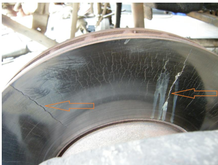
Рис. 3.6. Тріщина на гальмівному диску
