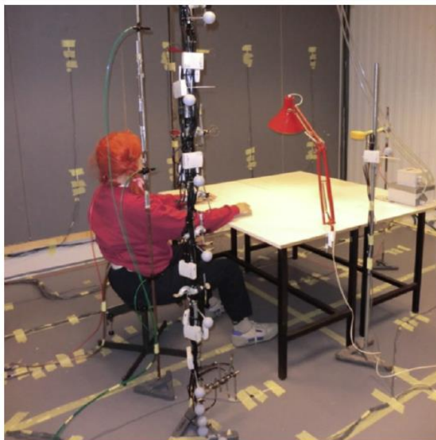
Рис. 1.2. Экспериментальное оборудование в комнате для исследования параметров воздушной среды [145]
