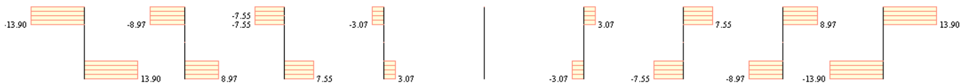
Рисунок 4.11 – Епюри крутних моментів у поперечних балках, Н·м
