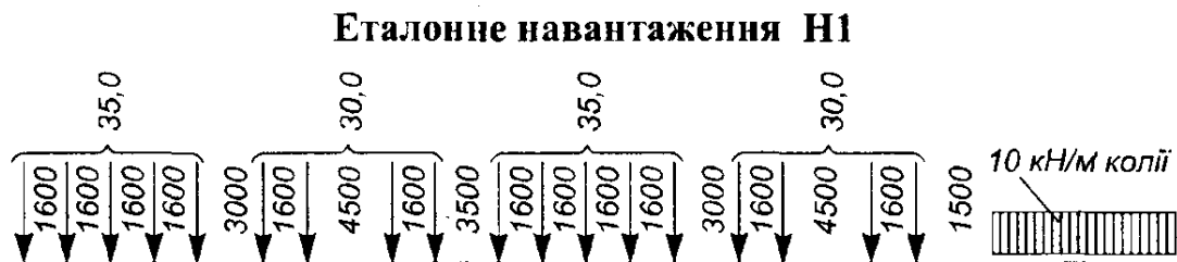
Рисунок 2.4 – Схема еталонного навантаження
