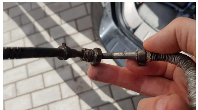
Рис. 4.10. Заміна датчика у DPF
