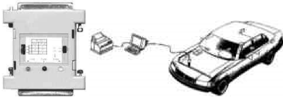
Рис. 3.15. Діагностування автомобіля за допомогою спеціалізованого діагностичного комп'ютера типу ADC2000
