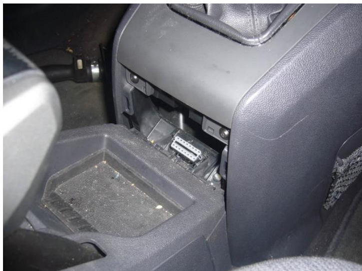
Рис. 3.11. Діагностичний роз'єм Opel Zafira B [13]
