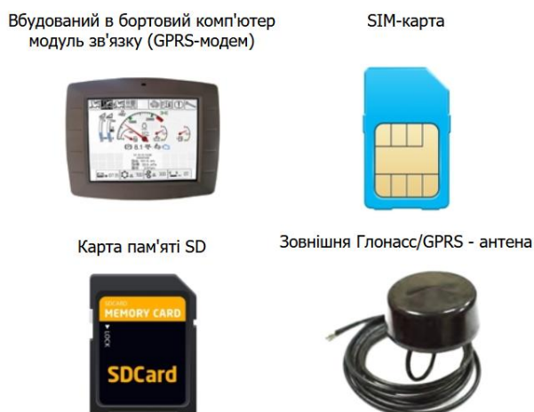
Рис. 2.2. Компоненти системи дистанційного моніторингу Agrotronic
