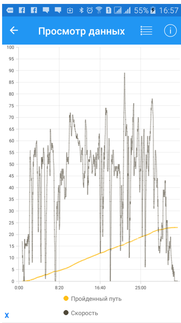
Рис. 2.8. Епюра швидкостей та шляху руху автомобіля
