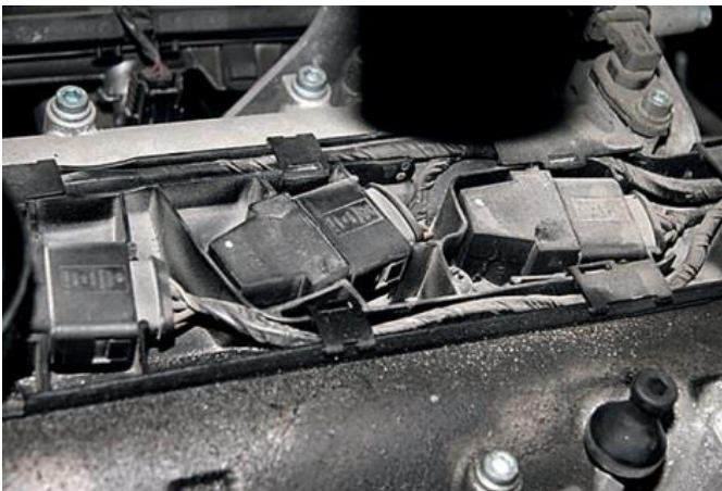
Рис. 3.1. Відмова індивідуальних катушок запалювання
