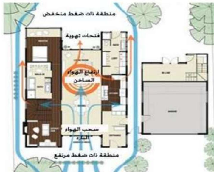
Малюнок № (11): Рух повітря через будівлю.
