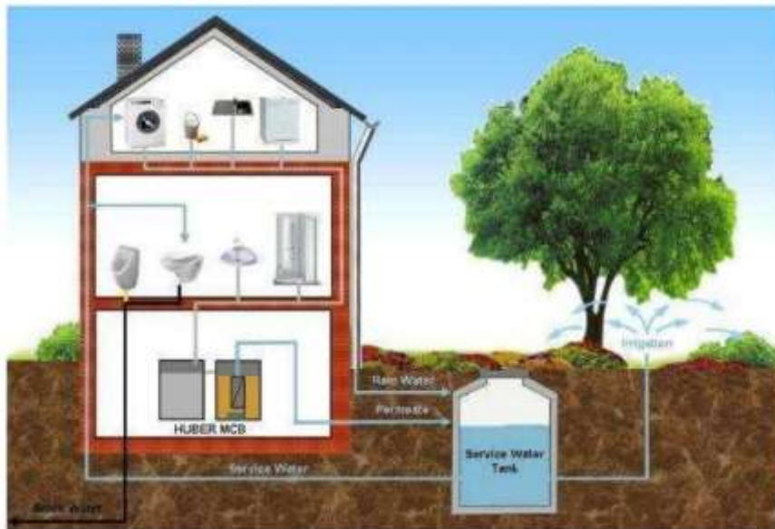
Рисунок № (10) : Методи збереження внутрішніх вод - очищення сірих вод.
