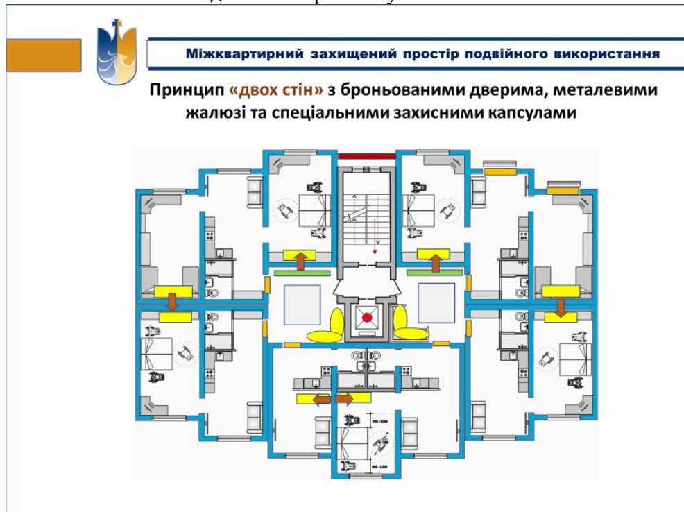
Рис. План модульного капітального житлового будинку з міжквартирним укриттям подвійного використання
