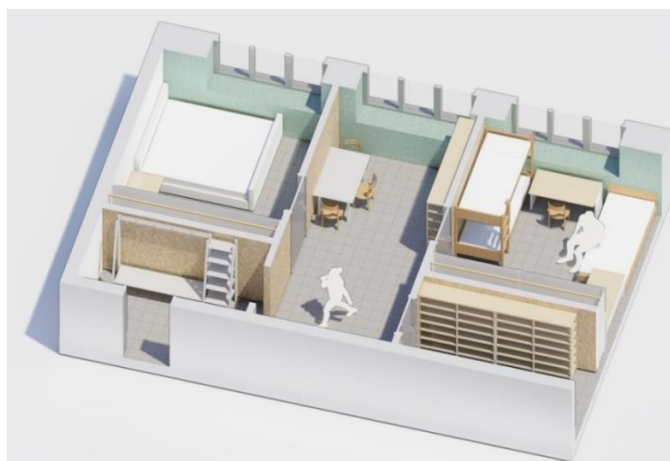
Рис. 7. Планувальне рішення облаштування перегородкових купе для середньотривалого розселення переселенців у класних кімнатах будівлі школи: а – схема розташування перегородкових конструкцій з прив'язкою до планування класної кімнати (1, 4 – стіл; 2, 3 – ліжка; 5 – шафа); б – візуалізація варіантів планування перегородкових купе
