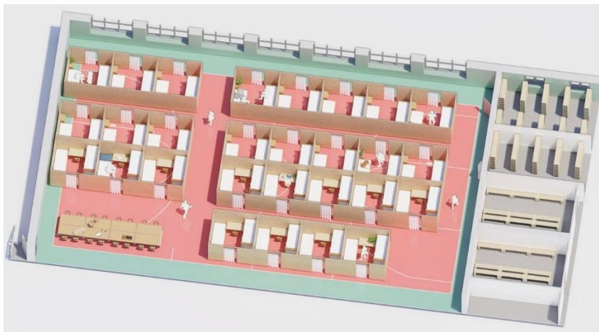
Рис. 5. Організація розміщення перегородкових купе на 112 осіб у великих приміщеннях типу спортзалу: а – схема розміщення перегородкових конструкцій у прив'язці до плану приміщення (1 – поверхні для повсякденних дій, 2 – перегородкові купе, 3 – приміщення для зберігання речей); б – візуалізація приміщення спортзалу з перегородковими конструкціями
