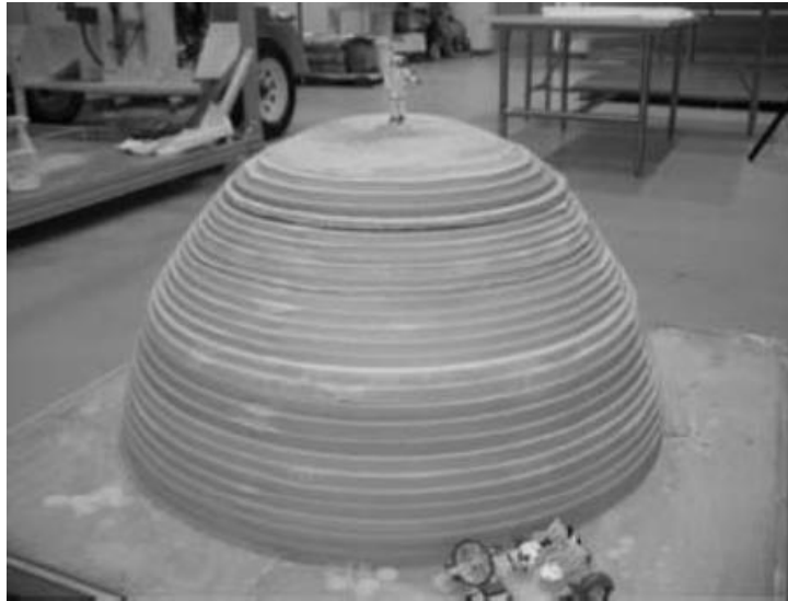
Рис. 1.11. Прототип місячного модуля у формі купола, надрукованого 3D-принтером
