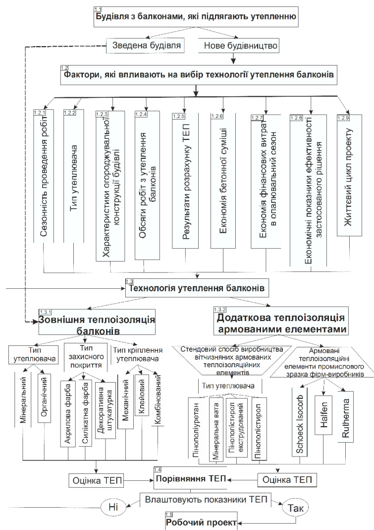
Рис. 6. Методична схема вибору раціонального варіанту технології робіт із теплоізоляції балконів житлових будинків
