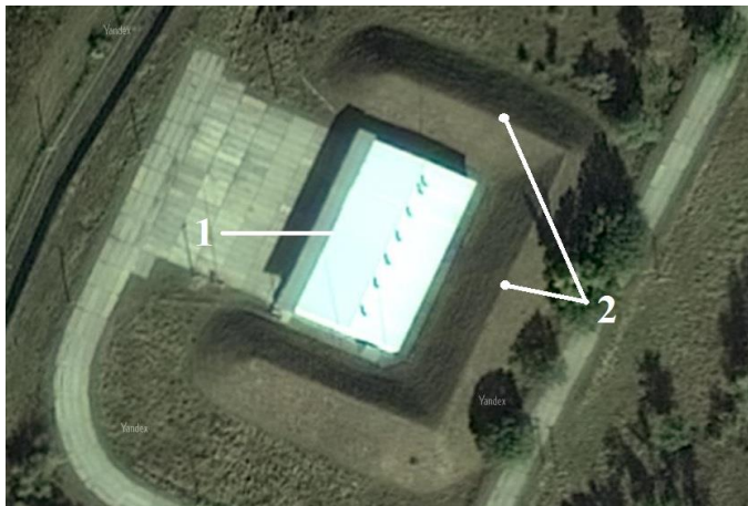
Рис. 3. Сховище ТРП: 1 – будівля сховища; 2 – захисний вал
